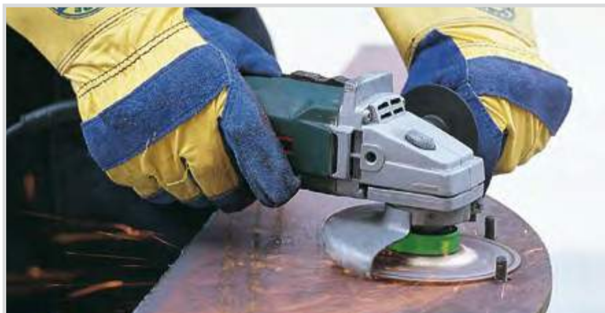
Taglio a raso possibile grazie alla conformazione a centro depresso.
