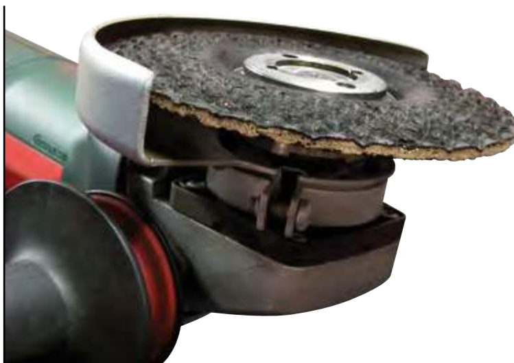
Completa scomparsa della ghiera di fissaggio nella depressione della cupola mola.
